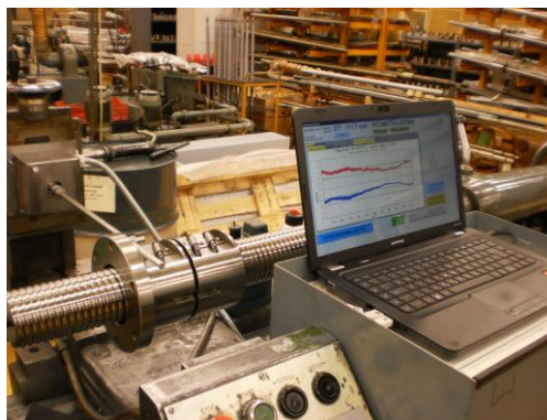
Szánszerkezetre telepített mérő-, megjelenítő PC-s (laptopos) rendszer ill. a vezérsoró végére épített inkrementális útmérő védőburkolat alatt
