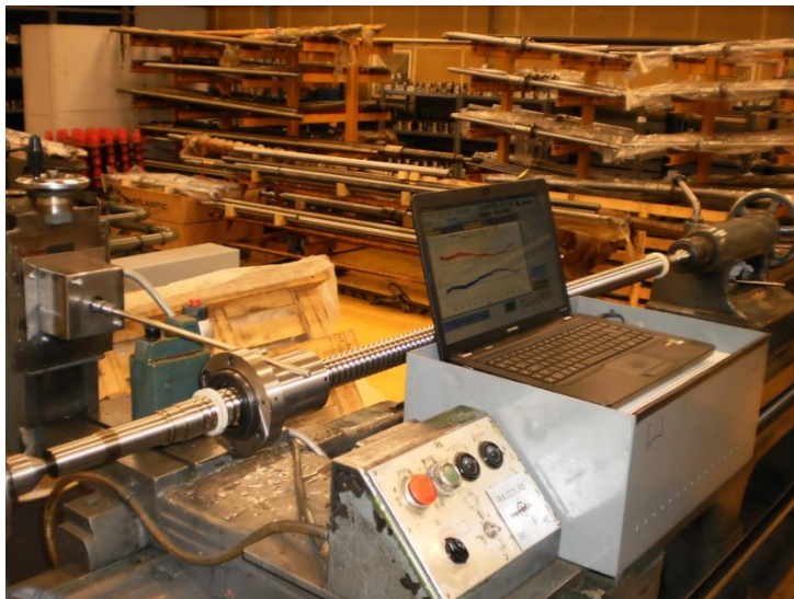
Golyósorsó-vizsgáló tesztberendezés egy régi esztergagépre telepítve
