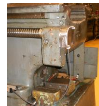
Szánszerkezetre telepített mérő-, megjelenítő PC-s (laptopos) rendszer ill. a vezérsoró végére épített inkrementális útmérő védőburkolat alatt
